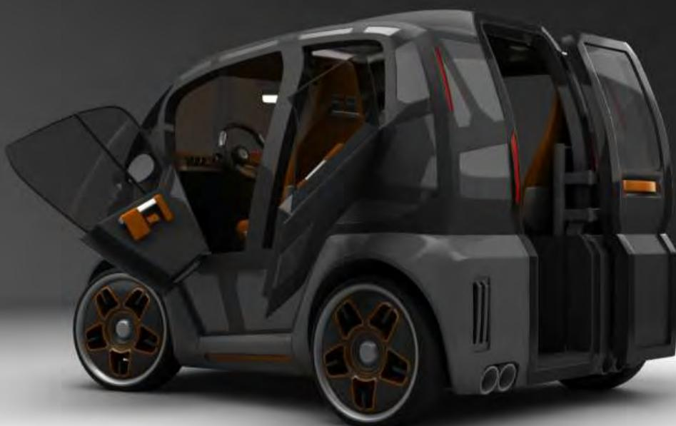
Боковые двери предназначены только для аварийной эвакуации из автомобиля. Они имеют не очень большой размер и расположены довольно высоко от земли, что бы обеспечить максимальную жесткость кузова, а мощнейший силовой элемент внутри этих дверей, способен выполнить роль настоящего щита безопасности, даже в случае очень серьезной аварии.
